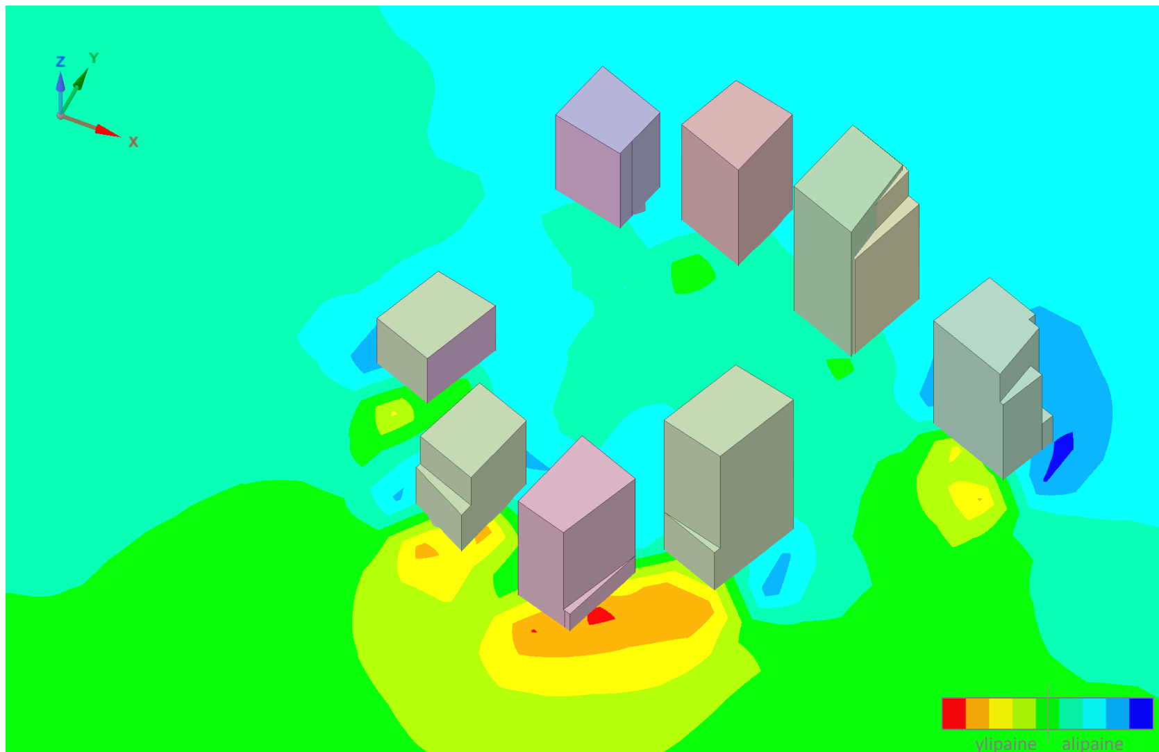
Kuva 61 Kalasataman keskuksen tornitalot kaakosta päin katsottuna ja etelätuuli puhaltaa 15 m/s. Kuvassa näytetään ilmavirtauksen aiheuttaman paineen jakautuminen leikkauskuvassa noin 75 metrin korkeudelta merenpinnasta. Lämmin värisävy kertoo suuresta paineen määrästä.
